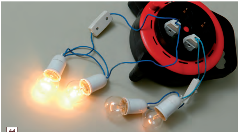
Efectes de la caiguda de tensió.
