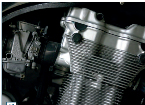
10 Bloc de motor refrigerat per aire.
