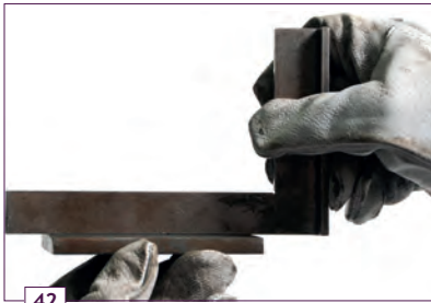
42 Verificació de planitud amb escaire.
