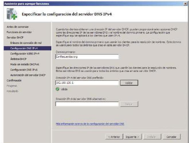
3.27. Especificar la configuración del servidor DNS IPv4.
